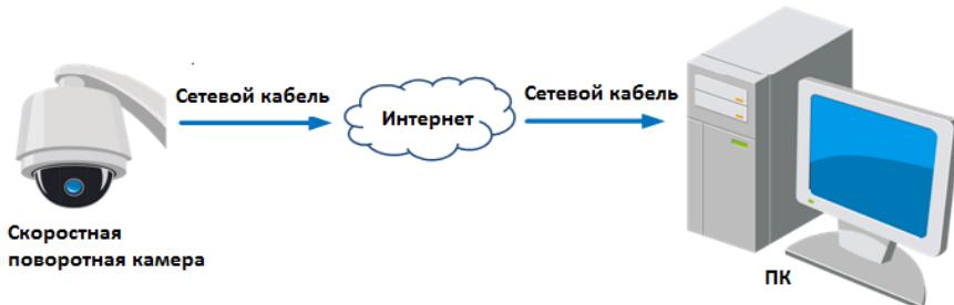
Рисунок 2-11 Доступ напрямую к камере со статическим IP-адресом
