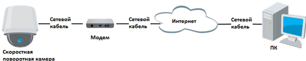
Рисунок 2-12 Доступ к камере с динамическим IP-адресом
